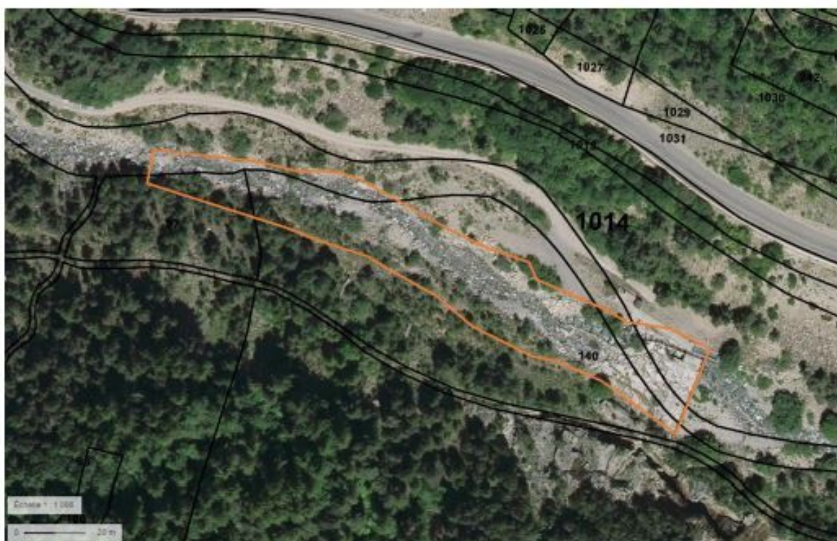
Figure 1 - Emprise de la modification du profil du lit du torrent sur 200 m à l'aval de la prise d'eau - Vue aérienne
